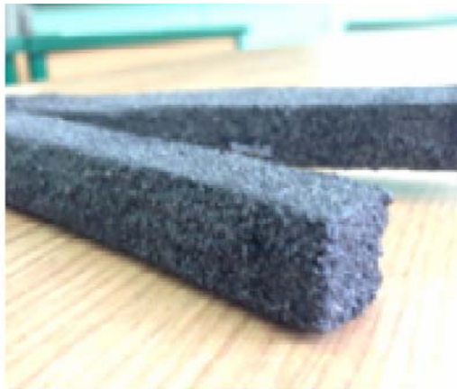
Рис. 8. Поверхность отливки, полученной при ЛГМ с вакуумированием
